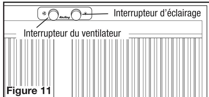
**REMARQUE :** Sur les installations où un ventilateur à une (1) seule vitesse est utilisé, tous les contrôles du ventilateur opèrent à la même vitesse. Sur les installations où un ventilateur à deux (2) vitesses est utilisé, les vitesses MOYENNE et HAUTE opèrent à la même vitesse.
