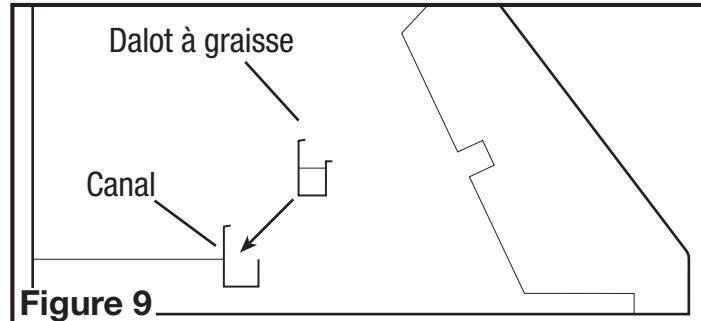
3. Installez les filtres déflecteurs en insérant le haut du filtre dans le canal du haut de la hotte, puis glissez le bas du filtre dans le canal du bas. Les filtres ont un sens pour le haut et le bas. Le bas sur le filtre aura des petits trous pour le drainage. Ces trous doivent faire face vers le bas en direction du dalot à graisse pour être efficaces (Figure 10).
